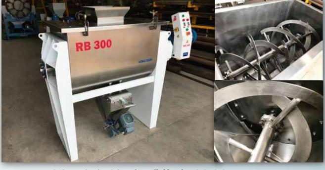
Sua característica principal é a alta eficiência global do processo. O Helicóide misturador interno obtém um alto índice de uniformidade na mistura em tempo reduzido por batelada quando comparado aos sistemas convencionais, como por exemplo o Misturador Vertical e o Misturador em Y.
